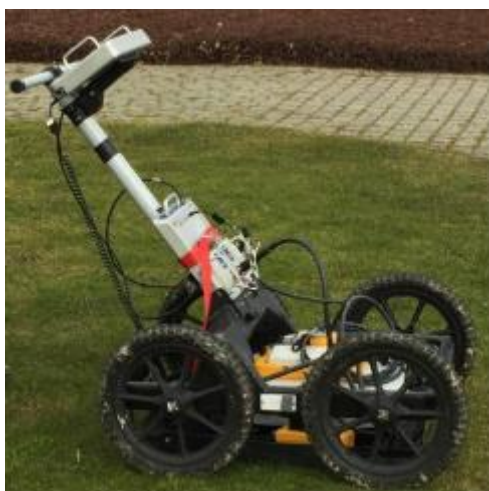
Figur 1 MALÅ 2D GPR med 500 MHz antenne
